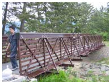
FRP歩道橋の加振による構造性能確認実験
