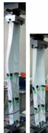
GFRP材の圧縮試験
